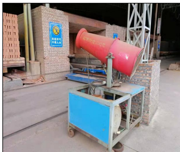
雾炮喷淋装置
